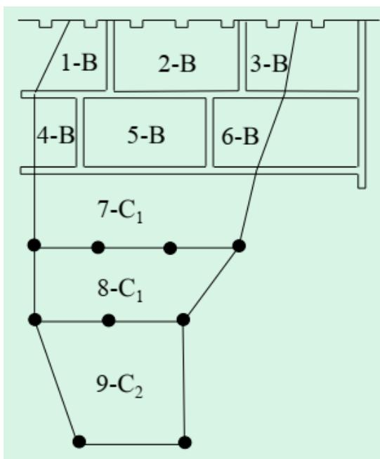
**Пример ответа:** Метод геологических блоков. Каждое рудное тело изображают и оконтуривают на проекции. Рудное тело на проекции делят на подсчетные блоки, запасы в каждом блоке считаются по отдельности.
