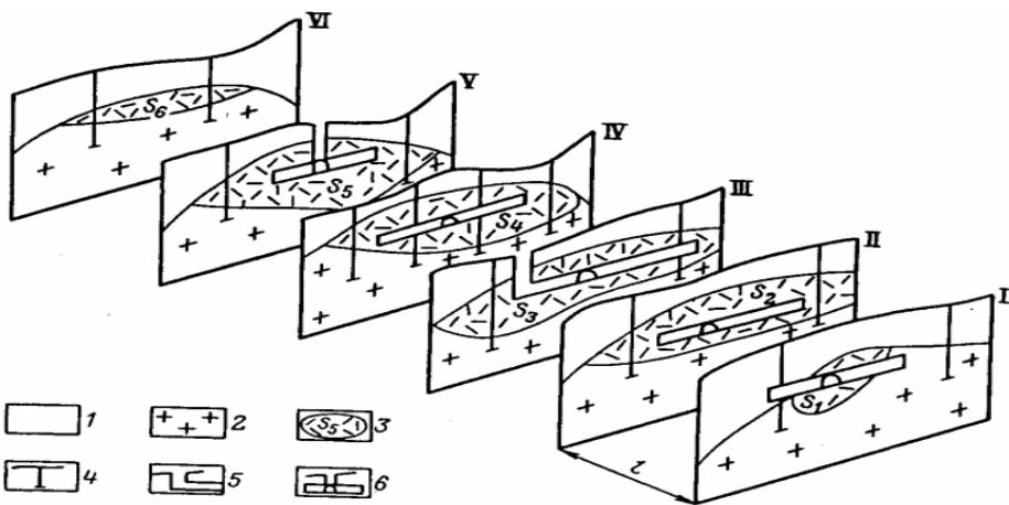
**Пример ответа:** Метод разрезов или параллельных сечений. Изображены вертикальные разрезы (сечения). Для определения запасов сначала подсчитывают запасы между соседними выработками на разведочной линии в ленте шириной 1 м. Затем рассчитывают запасы руды и металла в блоках между линиями.
